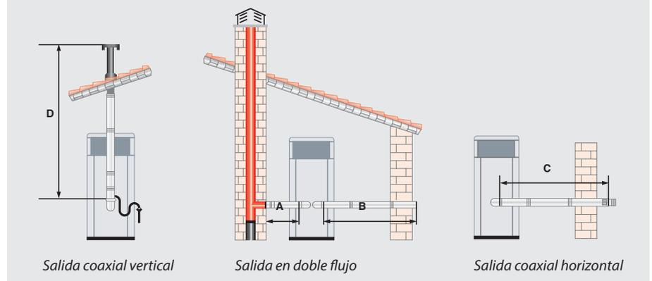
1 Codo de 90° (o 2 de 45°) equivale a 1 m. de longitud. Un metro horizontal equivale a 2 metros.
